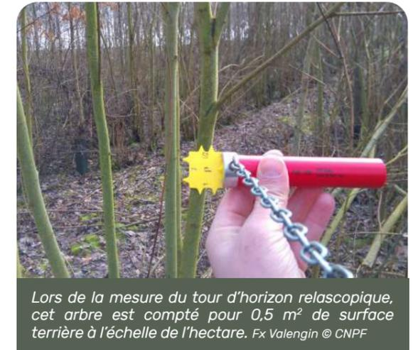
Lors de la mesure du tour d'horizon relascope, cet arbre est compté pour 0,5 m<sup>2</sup> de surface terrière à l'échelle de l'hectare. Fx Valengin © CNPF
