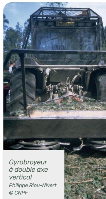
Gyrobroyeur à double axe vertical
