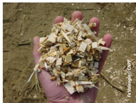
Les plaquettes doivent être calibrées selon le type de chaudière, le taux d'humidité est aussi essentiel.
