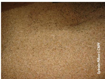
Les granulés sont en sacs ou en vrac avec un taux d'humidité inférieur à 10 %.
