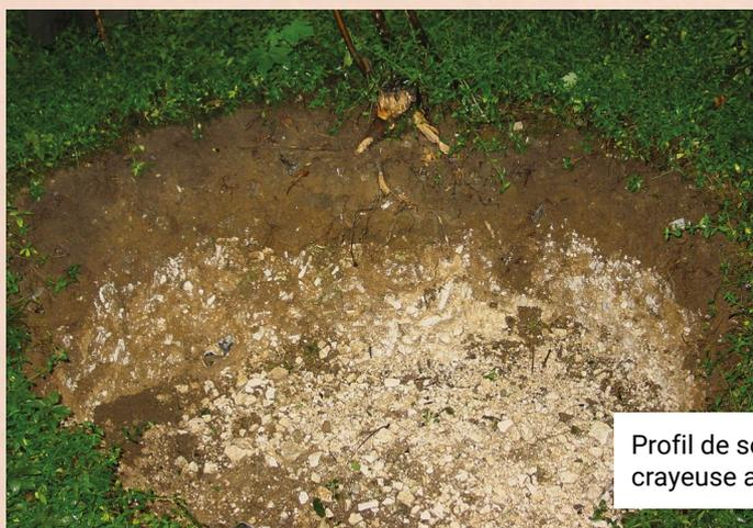
Profil de sol superficiel où l'on voit que la roche crayeuse arrive rapidement (ici à 40 cm de profondeur).
