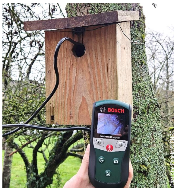
Figure 6 : Suivi de l'occupation et de la nidification dans les nichoirs à l'aide d'un endoscope
