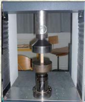
Essai de résistance à la compression sur un échantillon de Chêne Pubescent.
