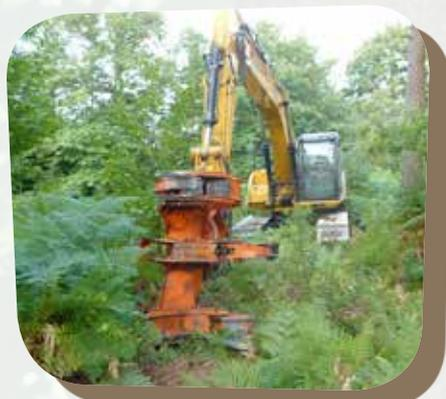
Tête de cisaille pour pelle hydraulique avec fonction accumulateur de tiges
