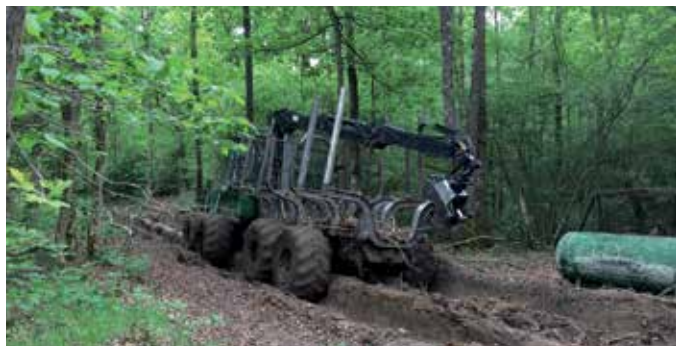
Les engins d'exploitation forestière peuvent entraîner la formation d'ornières lorsque les sols sont trop humides.
