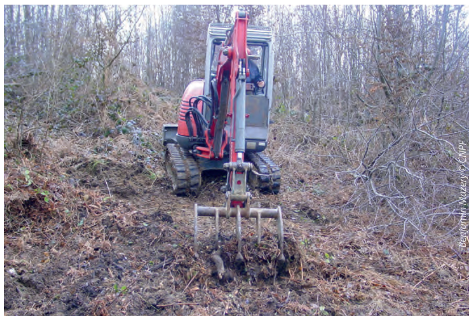
Le scarificateur élimine les rhizomes des Fougères et la Ronce
