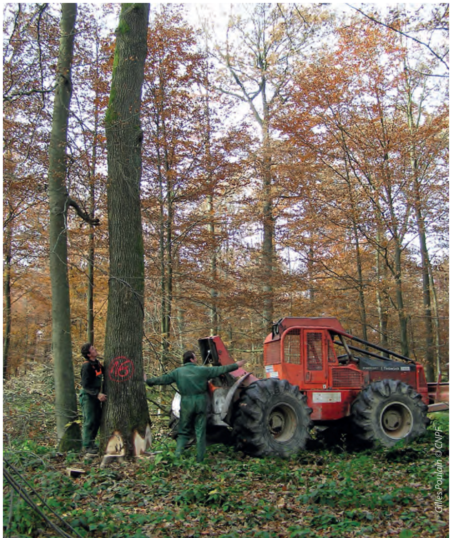
Le débusqueur permet de diriger l'abattage et de sortir les grumes
