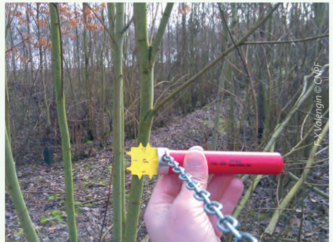
La jauge d'angle permet de mesurer la surface terrière. Elle est indispensable pour décrire et gérer un peuplement.
