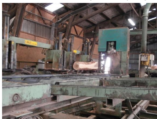
Figure 4 : Sciage en plot.
