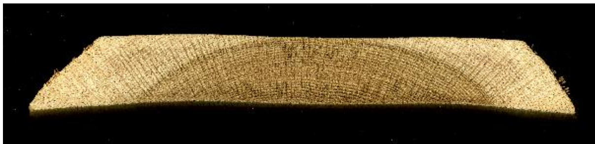
Figure 15 : Photo d'une section de plateau contenant du collapse.
