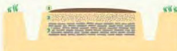
**Choix des matériaux :** pour une chaussée confortable, on peut choisir une grave de 0-40 en couche de fondation et une grave de 0-20 en surface. Une grave plus grossière est utilisée en couche de fondation car elle est moins chère.
