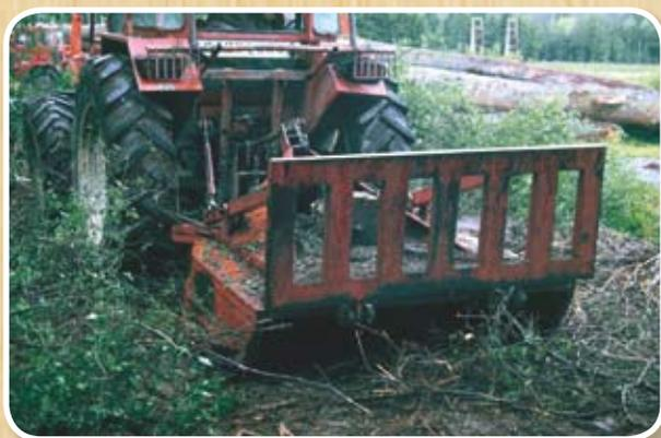
L'interligne est aussi déterminé par la largeur du gyrobroyeur
