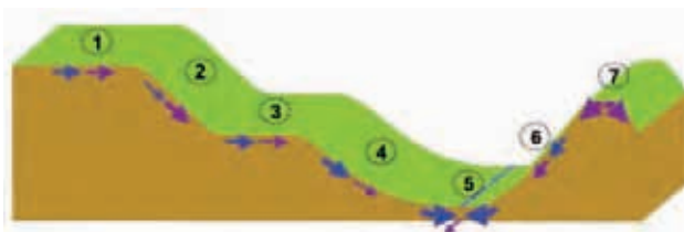
Schéma de la circulation des eaux superficielles en fonction du relief (la taille des flèches est proportionnelle à l'importance des transferts)
