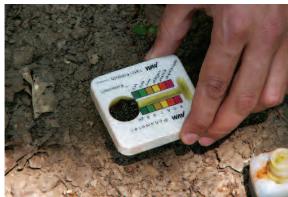
Le pHmètre colorimétrique
