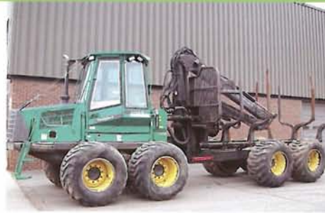
Ce porteur pèse 15 tonnes à vide, et il en existe de plus lourds...
