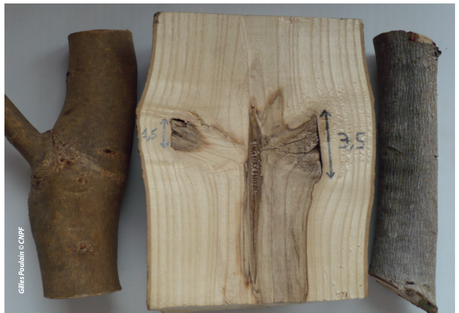
Il faut viser la coupe de branches de petit diamètre (à gauche) pour limiter la dégradation du bois (à droite)
