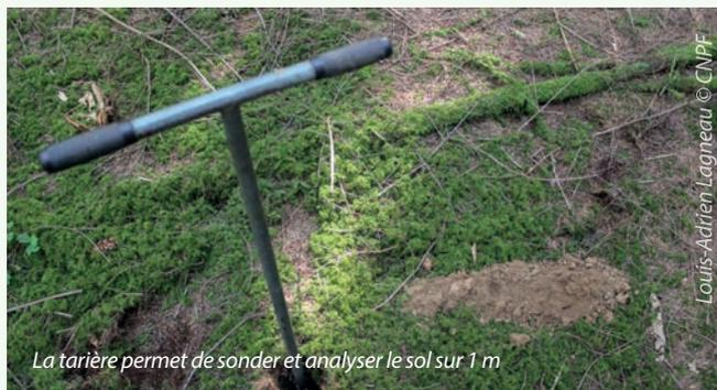
La tarière permet de sonder et analyser le sol sur 1 m
