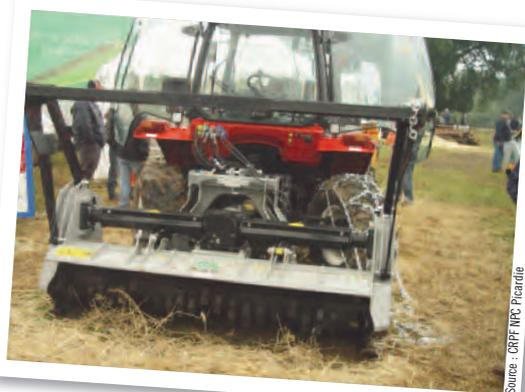
Broyeur à axe horizontal
