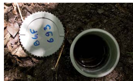
Nappe à proximité de la surface observée dans un piézomètre.
